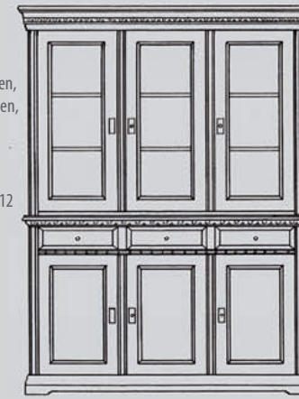
AD-012B Vitrinenschrank 5-trg. 4 Schubladen, 2-tlg. Oben: 2+2 Holzfachböden, Unten: 1+1 Holzfachböden, Tiefe Oberteil = 41cm H/B/T: 190 x 149 x 50
